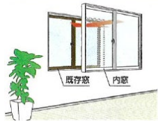
既存窓の内側に新たな窓を設置
